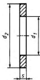
Пример условного обозначения уменьшенной шайбы для крепежной детали с диаметром резьбы 12 мм с толщиной, установленной в стандарте, из стали марки 08кп, с цинковым покрытием толщиной 6 мкм хромированным:
